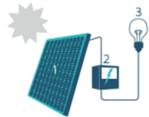
1. Zonnepaneel | 2. Omvormer | 3. Elektrische toestellen
